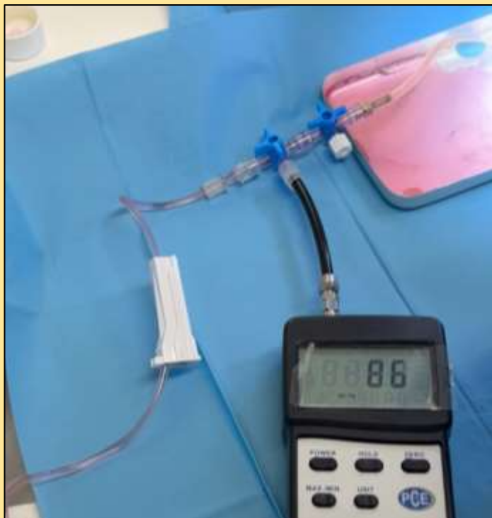
Monitoraggio della pressione durante il taglio per DASEK: manometro PCE-910 (PCE instruments)
